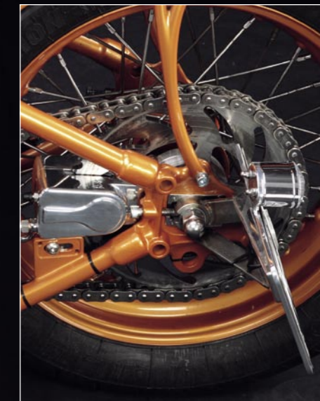
Unsichtbar: Kettenradbremse für dezenten Look und taugliche Verzögerung
